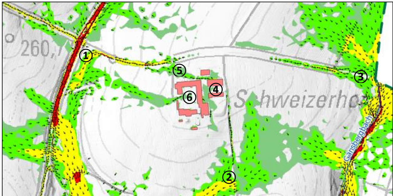
Abbildung 11: Die Fließgeschwindigkeit im Bestandsgelände „Schweizerhof“ für das Szenario „extrem“. Die Farbgebung stellt von grün über gelb nach rot die Fließgeschwindigkeiten „0,2 – 0,5 m/s“, „0,5 – 2 m/s“ sowie „> 2m/s“ dar. 11
